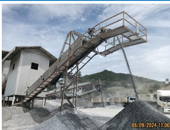
รูปที่ 3-13 สายพานลำเลียงแบบปิดคลุม
